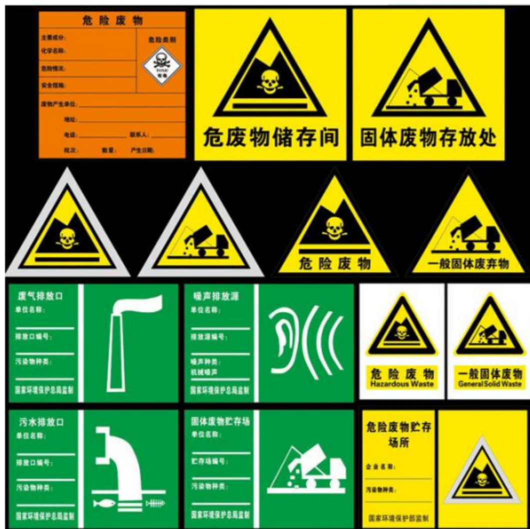
图 7.1-1 排污口规范化管理示意图
